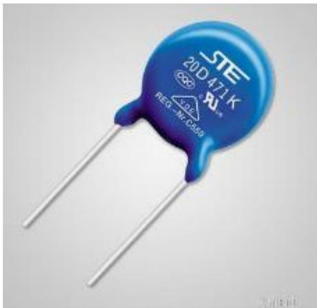
压敏电阻是一种限压型保护器件。利用压敏电阻的非线性特性，当过电压出现在压敏电阻的两极间，压敏电阻可以将电压钳位到一个相对固定的电压值，从而实现对后级电路的保护。压敏电阻的主要参数有:压敏电压、通流容量、结电容、响应时间等。
